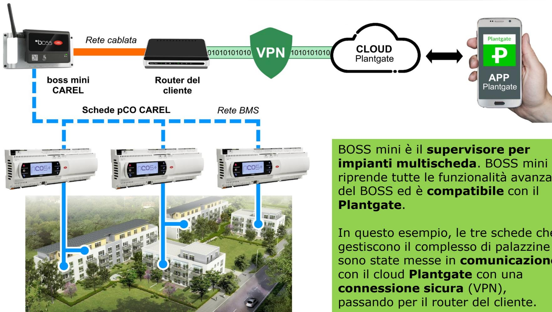
BOSS mini è il **supervisore per impianti multischeda**. BOSS mini riprende tutte le funzionalità avanzate del BOSS ed è **compatibile** con il **Plantgate**.
