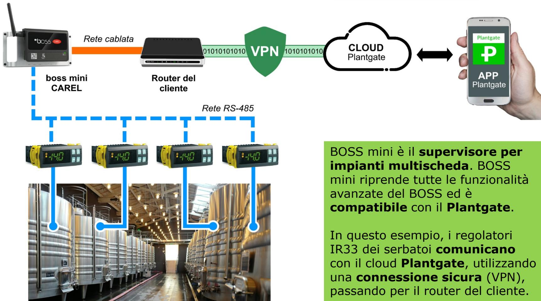
BOSS mini è il **supervisore per impianti multischeda**. BOSS mini riprende tutte le funzionalità avanzate del BOSS ed è **compatibile con il Plantgate**.
