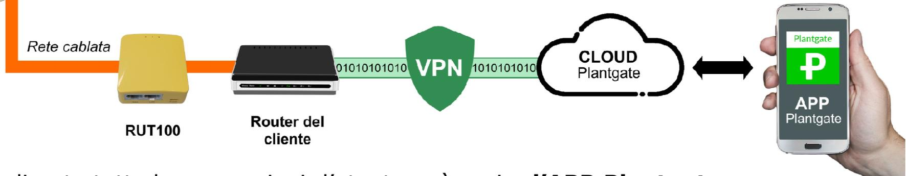
Realizzate tutte le connessioni, l'utente può aprire l'APP Plantgate e controllare la centrale termica da qualsiasi parte del mondo!
