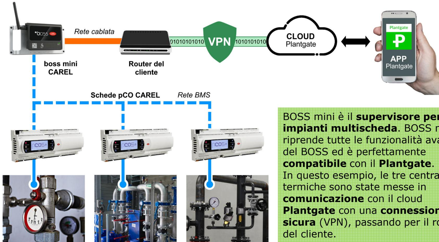
BOSS mini è il **supervisore per impianti multischeda**. BOSS mini riprende tutte le funzionalità avanzate del BOSS ed è perfettamente **compatibile** con il **Plantgate**. In questo esempio, le tre centrali termiche sono state messe in **comunicazione** con il cloud **Plantgate** con una **connessione sicura** (VPN), passando per il router del cliente.
